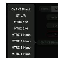
Ch 1/2 Direct es la salida antes del fader, y ST L/R, AUX y MTRX son las salidas después del fader.
