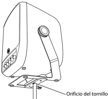
Use el orificio del tornillo (con un diámetro de 9,5 mm de diámetro) situado en la parte inferior del asa y un tornillo de 9 a 11 mm de longitud para instalar el altavoz en el pie de micrófono.
