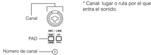
NOTA Si utiliza micrófonos de condensador, active [PAD] el interruptor [PHANTOM +48V].
