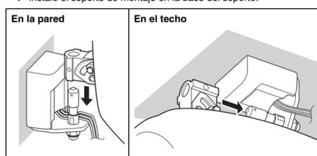
2 Coloque la pinza de seguridad. Asegúrese de fijar bien la pinza de seguridad para que el soporte de montaje no se caiga.
