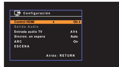
⑥ Si conectó el TV y la unidad mediante un cable digital óptico, use las teclas del cursor ( $\Delta/\nabla$ ) para seleccionar "Entrada audio TV", y las teclas del cursor ( $\leftarrow/\rightarrow$ ) para seleccionar "AUDIO 1".
