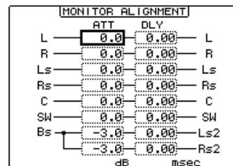
Los parámetros del atenuador pueden oscilar  $-\infty$ ,  $-12$  dB y  $+12$  dB, en incrementos de 0,1 dB. Los parámetros de retardo pueden oscilar entre 0 y 30 msec, en incrementos de 0,02 msec.
