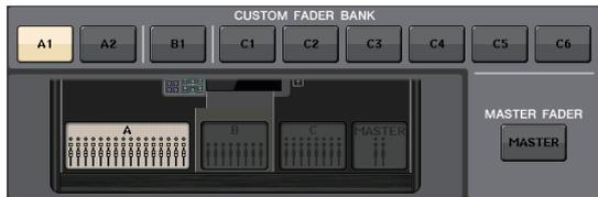
**5. Pulse el número en el área FADER y, a continuación, la tecla [SEL] correspondiente al canal que desee asignar a dicho deslizador.**
