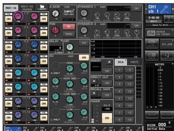
4. Pulse la tecla [SEL] de otro canal de entrada y ajuste la ganancia del amplificador principal de la misma manera.
