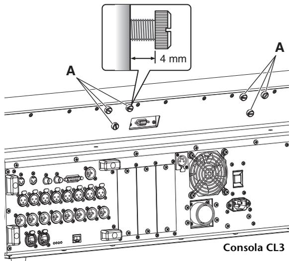
2. Enganche los orificios "B" de la placa de montaje MBCL en los tornillos "A" de la CL3/CL1.
