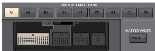
5. En el campo FADER, pulse el botón numérico de la banda de canales.
