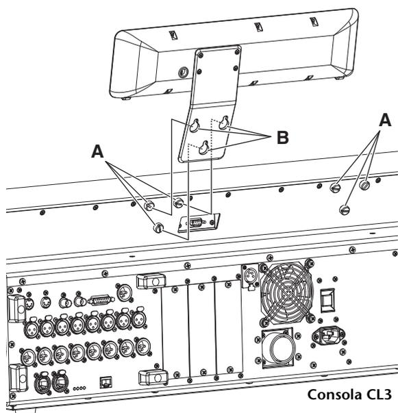
3. Apriete los tornillos "A" para sujetar la MBCL, empezando por los dos tornillos superiores.
