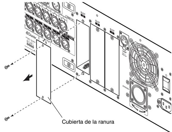
3. Alinee los extremos de la tarjeta con los carriles guía del interior la ranura e inserte la tarjeta en la ranura.
