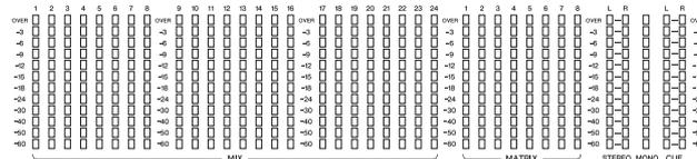
Indica los niveles de los canales MIX/MATRIX, STEREO/MONO y CUE. Podrá seleccionar la posición de monitorización entre PRE EQ (inmediatamente antes del EQ), PRE FADER (inmediatamente antes del atenuador) o POST ON (inmediatamente después de la tecla [ON]). Podrá utilizar esta función en los modelos CL3 o CL1 si instala un puente de vómetros MBCL opcional.
