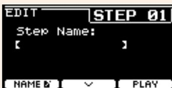
2. Utilice los botones bajo “^” y “v” ([F1] y [F2]) para mover el cursor y utilice los controladores [-][+] para seleccionar un ajuste.
