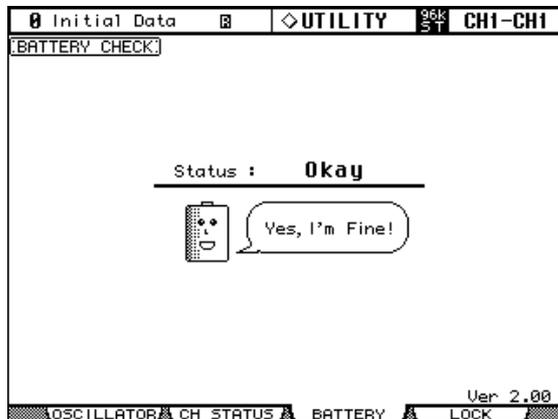
Si el estado es “Okay,” la batería está bien. Si el estado es “Getting Low,” contacte con su distribuidor Yamaha para cambiar la batería tan pronto como sea posible. No intente cambiar la batería usted mismo. Si no cambia la batería baja de carga puede provocar una pérdida de información.
