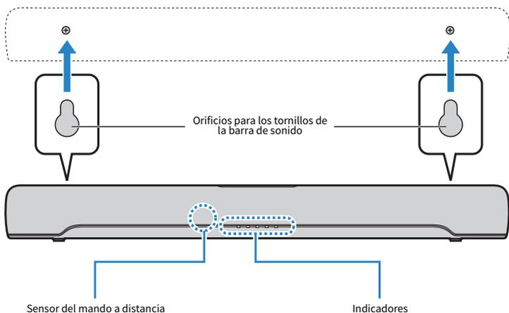
Una vez finalizada la instalación y establecidas todas las conexiones, con la barra de sonido apagada, mantenga pulsado BASS EXT en el mando a distancia de la barra de sonido durante al menos cinco segundos para optimizar el ajuste de características de frecuencia para montaje en la pared. Los indicadores muestran el estado de ajuste de la siguiente forma, y la barra de sonido se enciende.
