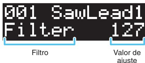
El filtro da forma al sonido al permitir que sólo pase un rango de frecuencias especificado y/o al producir un pico de resonancia a la frecuencia de “corte”. El filtro se puede utilizar para crear una serie de sonidos similares a los de un sintetizador.
