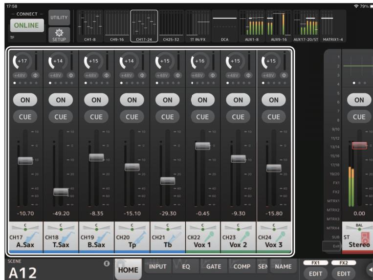
En el área de detalles aparecen las bandas de canales correspondientes a los 8 canales. Puede desplazarse a izquierda y derecha para ver las bandas de otros canales deslizando el dedo a izquierda o derecha en un área inactiva de la pantalla.
