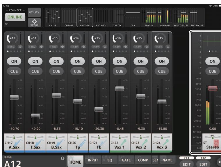
La banda de canal STEREO normalmente se muestra en el área de la banda general. Cuando se utiliza el modo SENDS ON FADER, aquí se muestra la banda del canal AUX, SUB o MATRIX.
