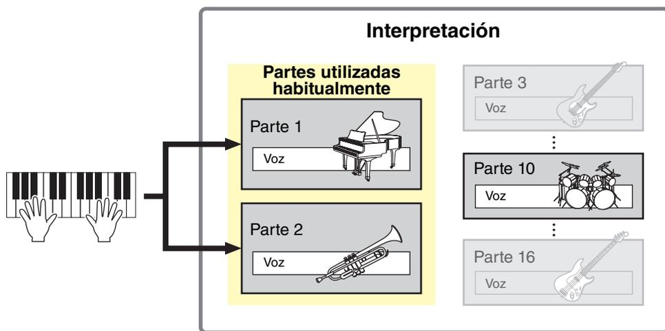
Las partes 1 – 16 tienen asignados distintos canales MIDI. Utilizando un secuenciador MIDI externo, el software DAW del ordenador o los datos MIDI de una memoria flash USB conectada al MX49/MX61 se pueden tocar hasta 16 partes a la vez.
