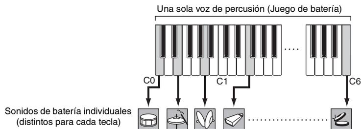
**NOTA** Los números de notas predeterminados asignados al teclado van de C2 a C6 (MX49) y de C1 a C6 (MX61). Si desea tocar notas que no se encuentran en el ámbito del teclado (C0 – C2 o C0 – C1), use los botones OCTAVE [-] o TRANSPOSE [-] para cambiar el tono del teclado.
