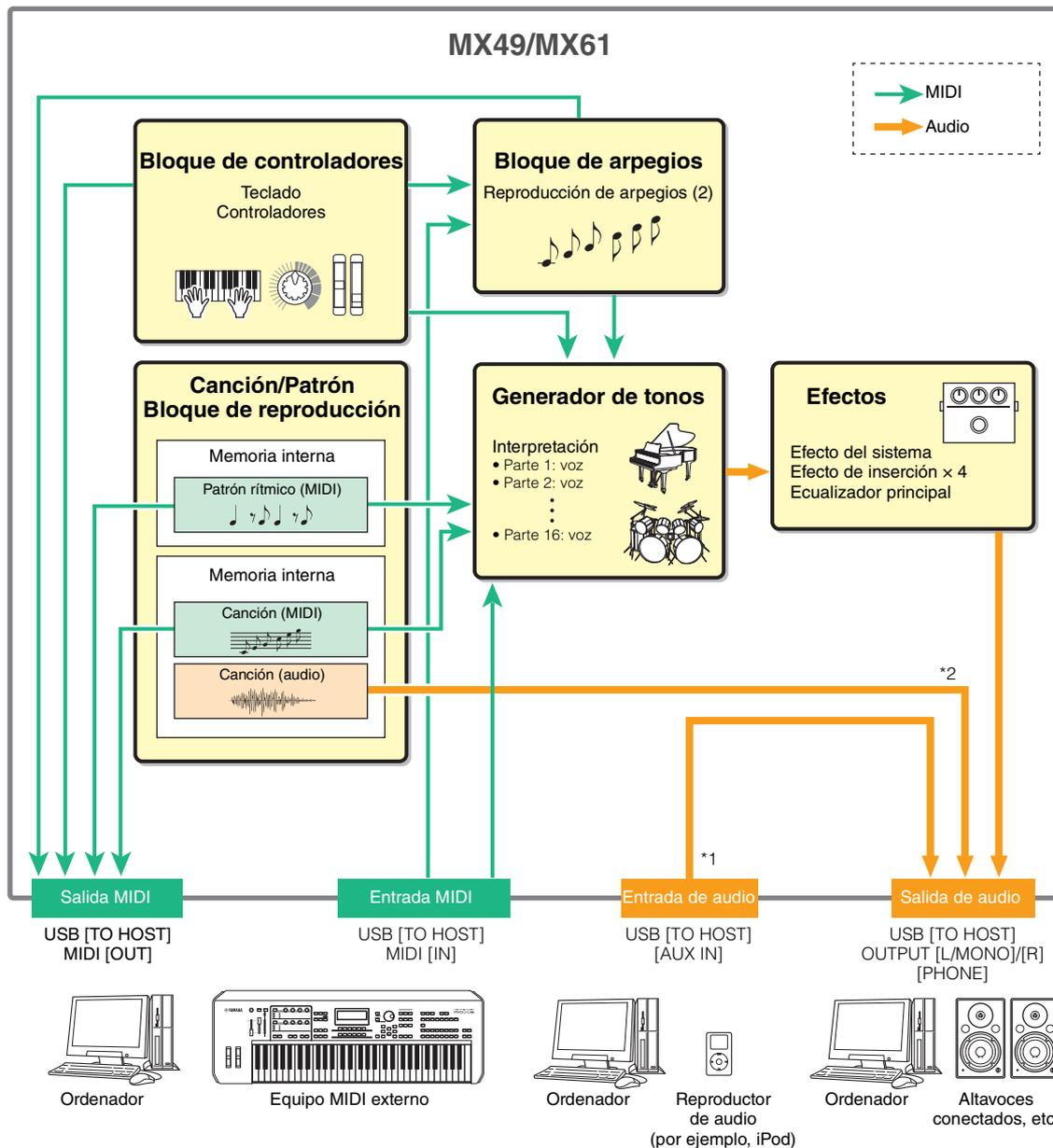
\*1 Las señales de audio con entrada en el terminal USB [TO HOST] tienen salida solo en las tomas OUTPUT [L/MONO]/[R] y la toma [PHONE]. No tienen salida en el terminal USB [TO HOST].
